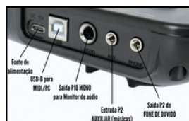
Saídas e entradas do módulo de som.
