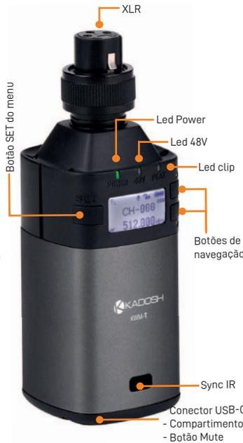
Este transmissor tipo plug-on é um produto da KADOSH que possibilita transformar qualquer microfone com fio em um sistema sem fio.
