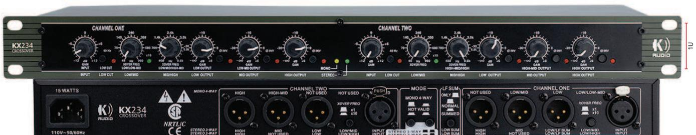
O KX234 é um crossover de canal duplo com todos os recursos que você necessita para o uso em seu sistema de áudio. Possui filtros Linkwitz-Riley 24dB por oitava, controles independentes de ganho de saída para correspondência de nível, inversão de fase de saída, filtro de corte baixo de 40 Hz e soma mono opcional da saída de baixa frequência (subwoofer).
